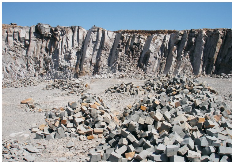
Figura 10: Riólito (granófiro) de cor cinza clara, constituinte do quinto derrame da sequência ácida superior da Formação Serra Geral, com fraturamento subvertical, que possibilita a obtenção de blocos e paralelepípedos regulares de rocha, usados para alicerce e calçamento. Pedreira da Brita Pinhal Indústria e Comércio Ltda. (Fotografia: Pedro Sartori, 2008).
